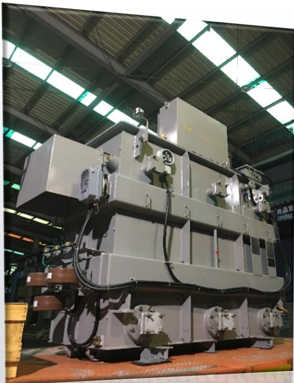
2019年7月完成台電 一期風機模組內變 壓器
