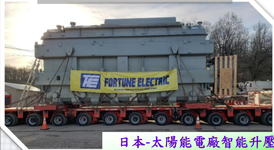
530kV 775MVA (國內最高電壓 最大容量)2020年1月抵達美國
