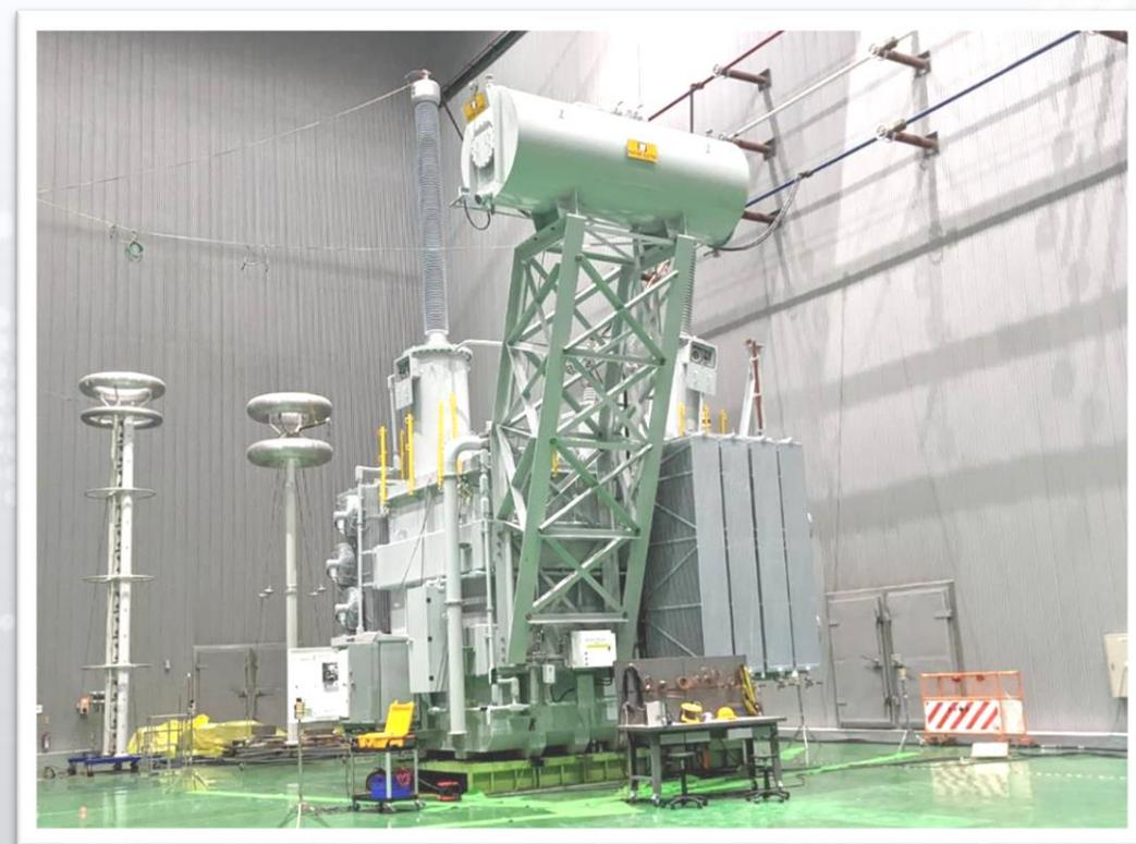
美國電力公司 525kV等級大型電力變壓器
