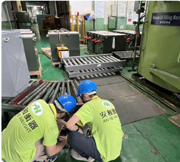
▲ 注油機荷重元裝設
