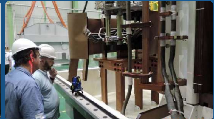
▲ 短路試驗後變壓器回廠，由 KEMA 技師進行心體目視
